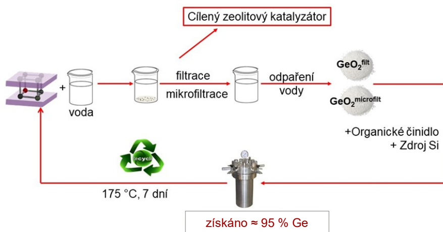
Obr. 9. Navržená metoda recyklace germania pro přípravu zeolitů
