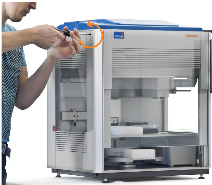
Figura 7. Abra a porta manualmente, rodando o parafuso para a esquerda.
