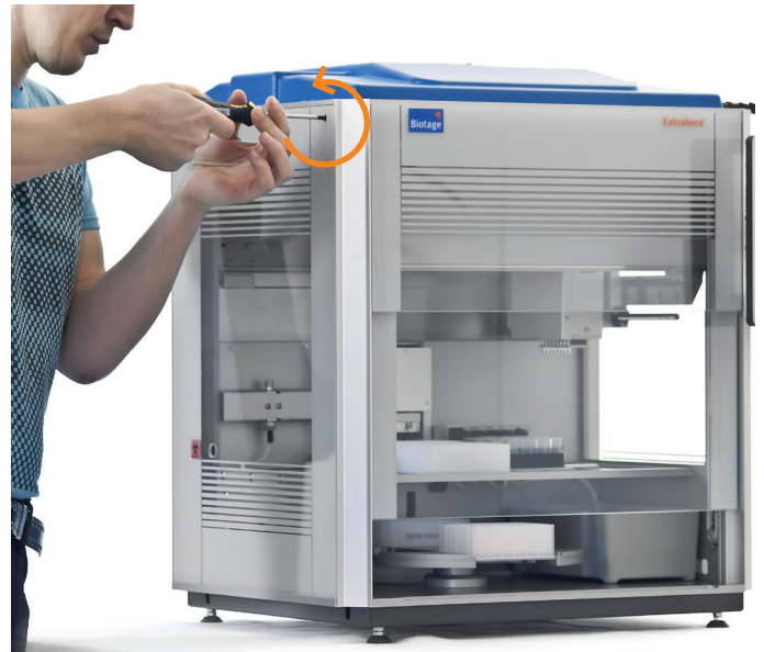
Figura 7. Abra la puerta de forma manual girando el tornillo en sentido contrario a las agujas del reloj.
