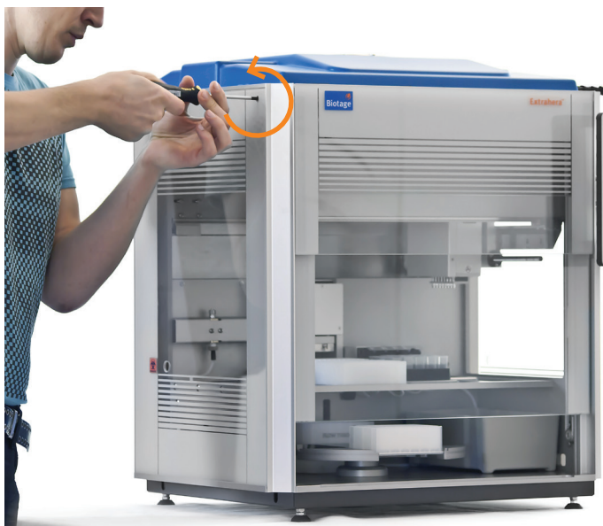
Figura 7. Aprire lo sportello manualmente ruotando la vite in senso antiorario.
