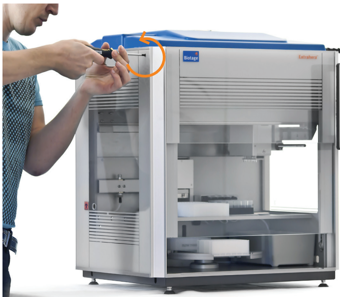
Figur 7. Åbn døren manuelt ved at dreje skruen imod urets retning.
