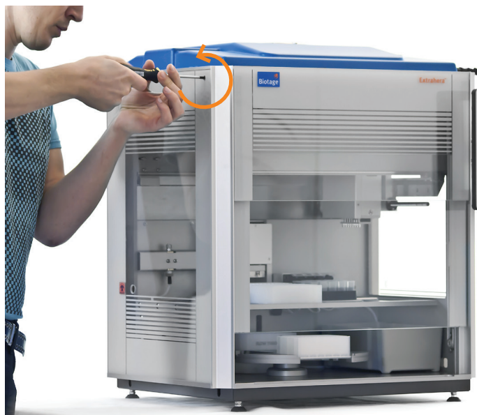
図 7. ネジを反時計方向に回して、ドアを手で開けてください。
