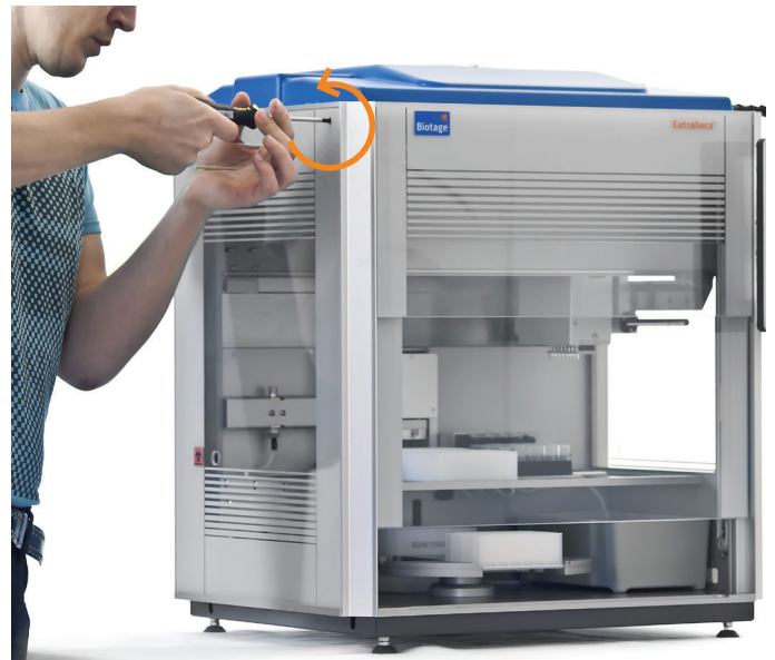
Illustration 7. Ouvrez la porte manuellement en tournant la vis dans le sens inverse des aiguilles d'une montre.
