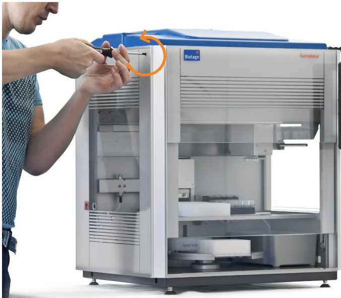
Kuva 7. Avaa ovi manuaalisesti kääntämällä ruuvia vastapäivään.
