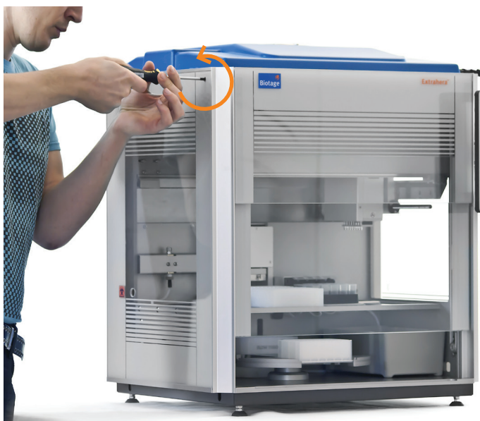
Bild 7. Öppna dörren manuellt genom att vrida skruven moturs.
