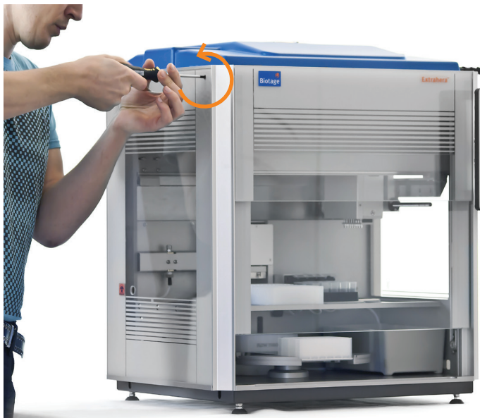
图7. 逆时针拧动螺钉，将舱门手动打开。
