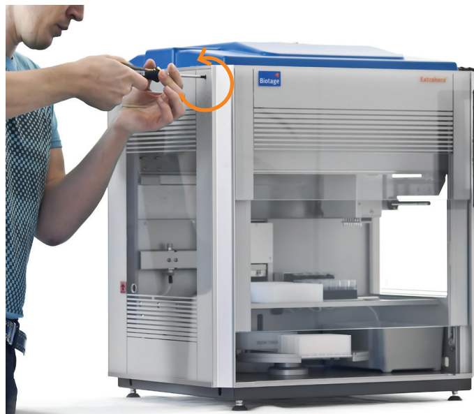
Afbeelding 7. Open de deur handmatig door de schroef linksom te draaien.
