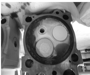
Obr. 1. Vnútro motora pokrytého vrstvou SiO 2
